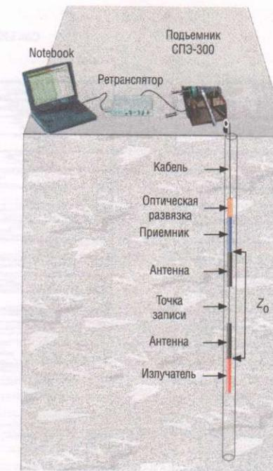
Рис. 1. Схема радиоволновых измерений ОРВП
