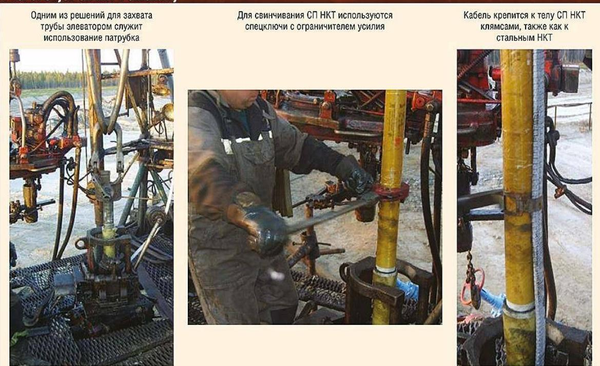
Рис. 7. Восстановление резьбового соединения СП НКТ
