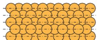
Рис. 1. Варианты использования технологии jet grouting для создания ограждающих конструкций котлованов
